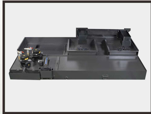
水箱單元+高壓泵浦
