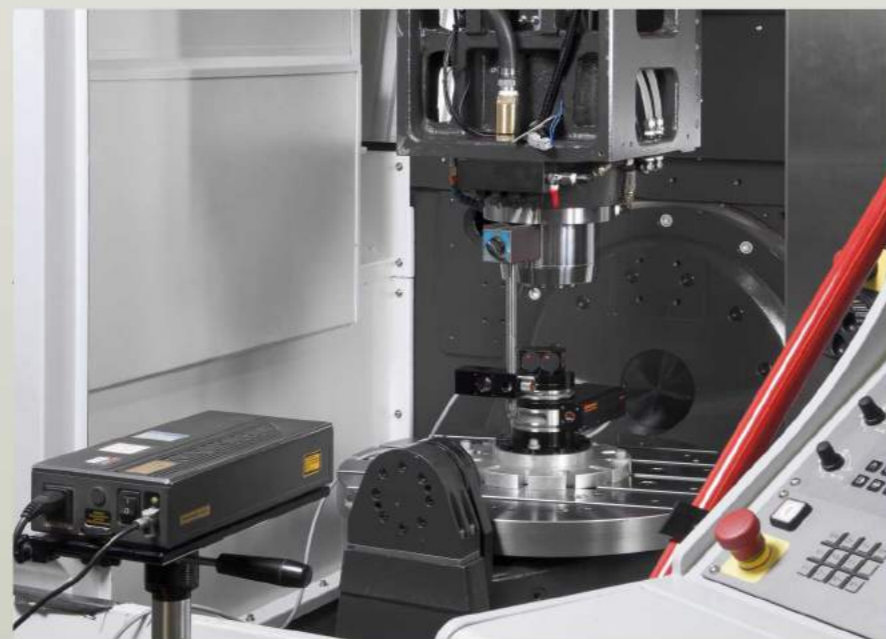
■ 工作台中心校正功能配置海德漢TS-740，高精度量測頭與標準量測球體配合海德漢量測軟體，可檢測工作台中心誤差值，補入控制系統以確保工作台中心的精度。
