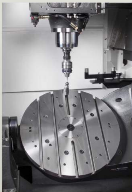
■ 工作台中心校正功能配置海德漢TS-740，高精度量測頭與標準量測球體配合海德漢量測軟體，可檢測工作台中心誤差值，補入控制系統以確保工作台中心的精度。
