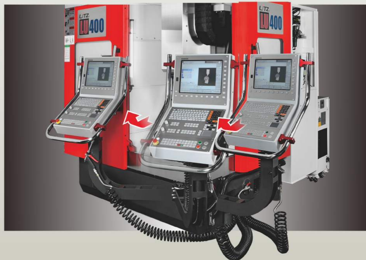
● 可移動式的操作箱，便於操作者於機器的正面或右側操作機台，也可依人體的高矮調整操作箱高度
