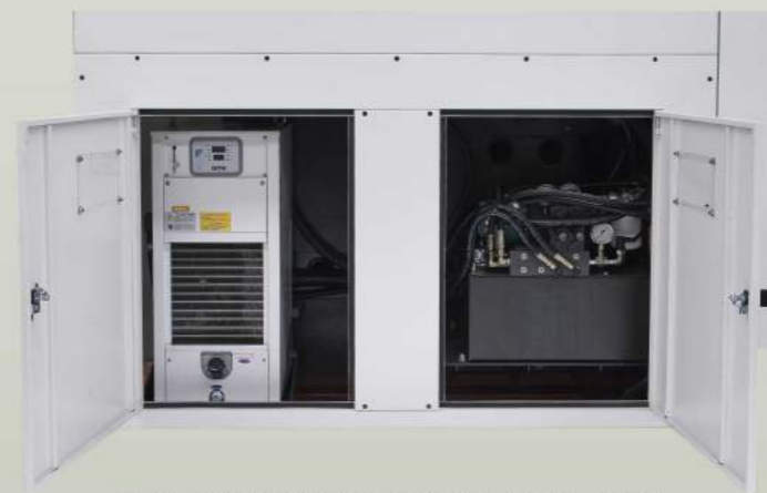
■ 機台油壓管路集中於機台後方，便於維修保養。
